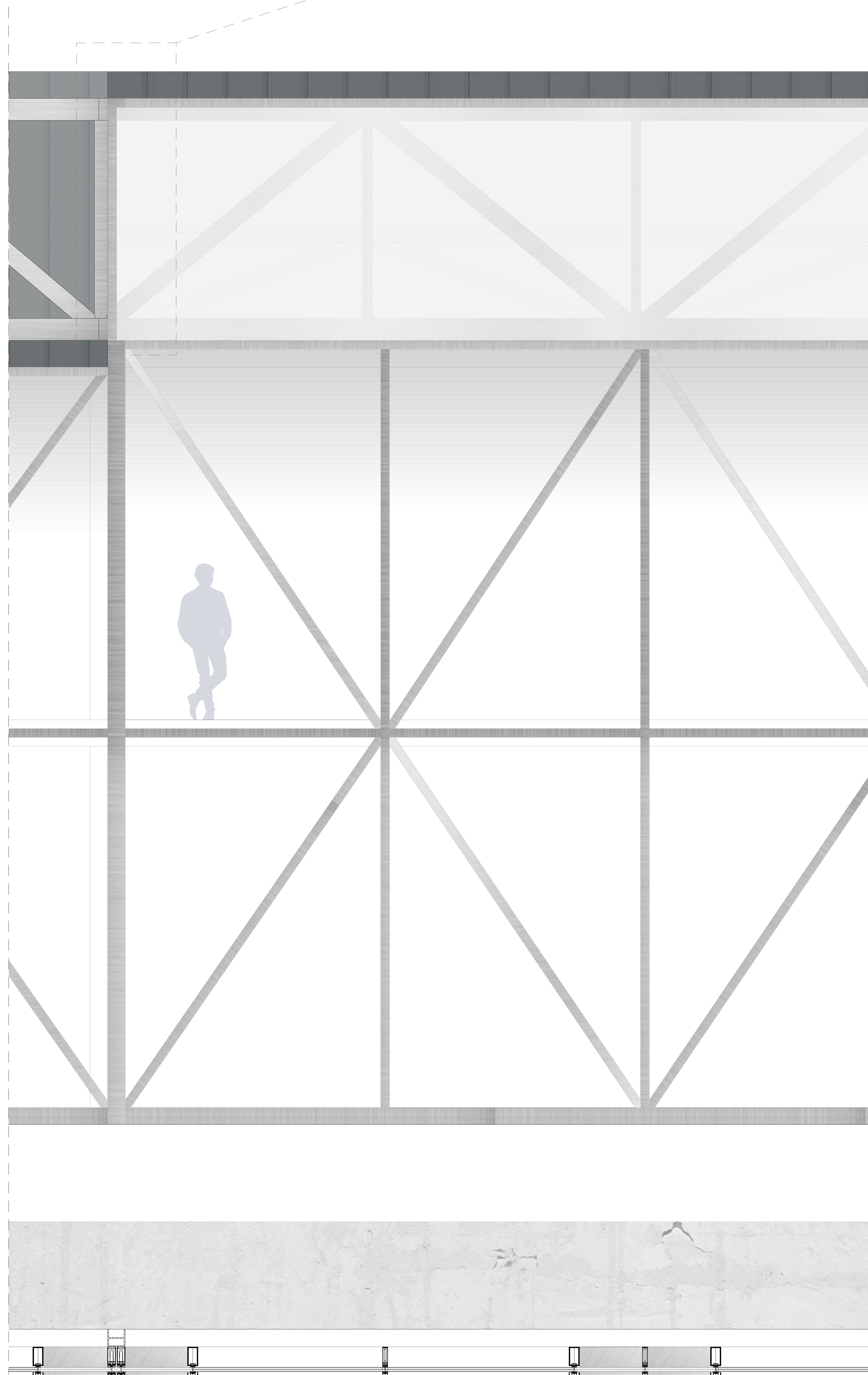
Fensteranschluss Fachwerkträger Maßstab 1:10
