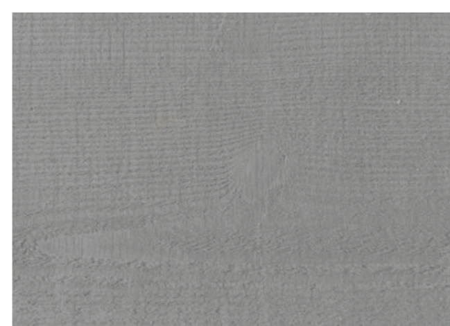
Fassade: vorvergrautes Lärchenholz
