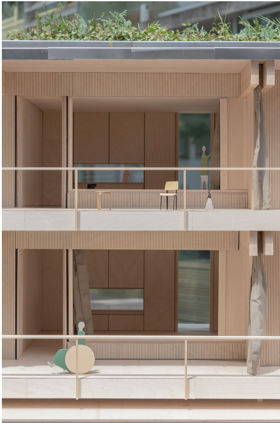
Fassadenschnitt mit Teilansicht (Foto) M 1:10
