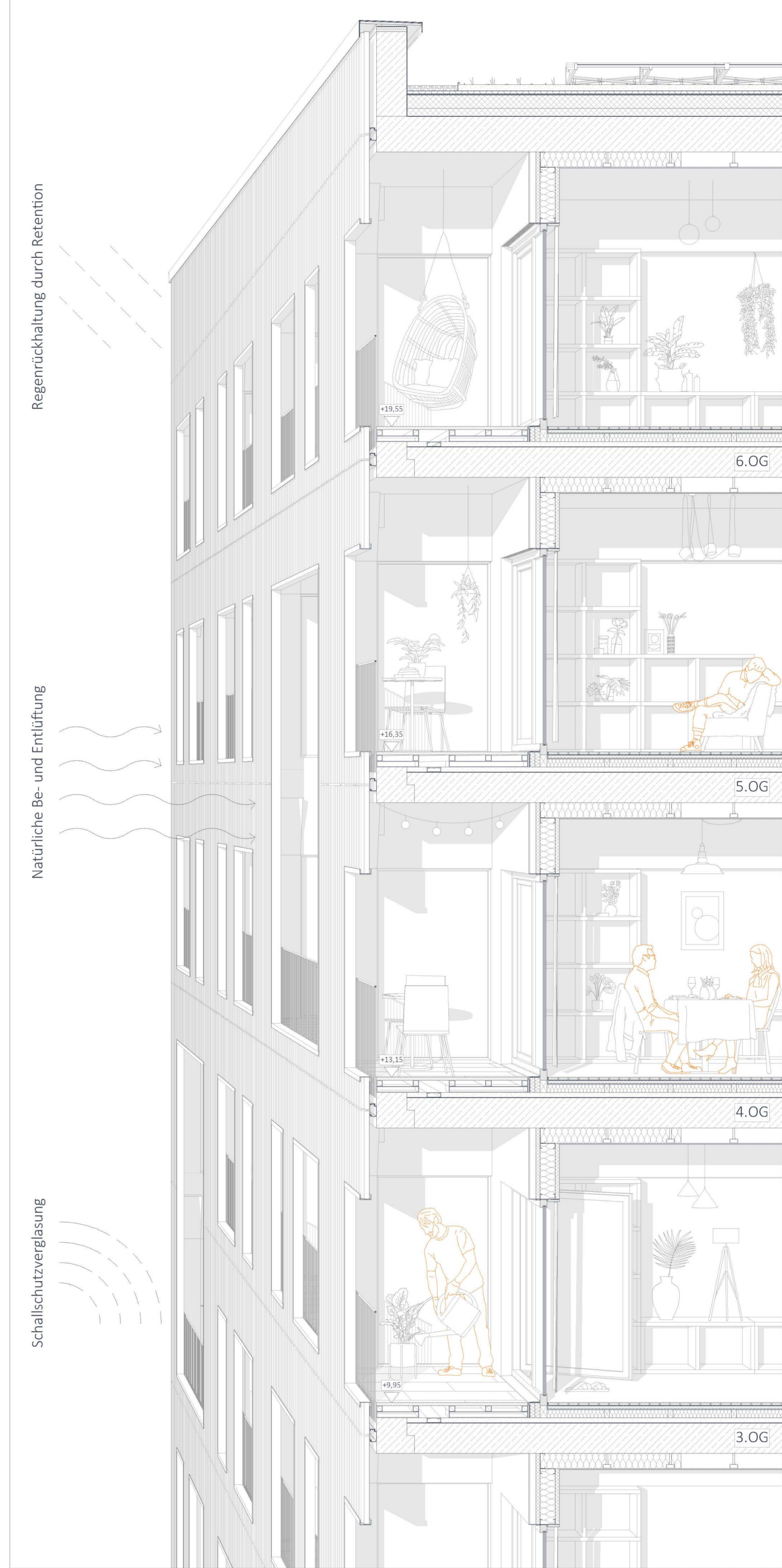
Fassadenausschnitt | Phase 2 | M 1:20
