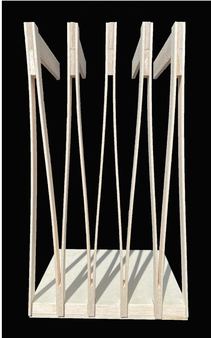
Teilausschnittsmodell Modell- Materialien: Pappel, Balsa Holz Stäbchen (1 LVL Streifen + 1 LVL Streifen) x 5 = 5 Astgabeln
