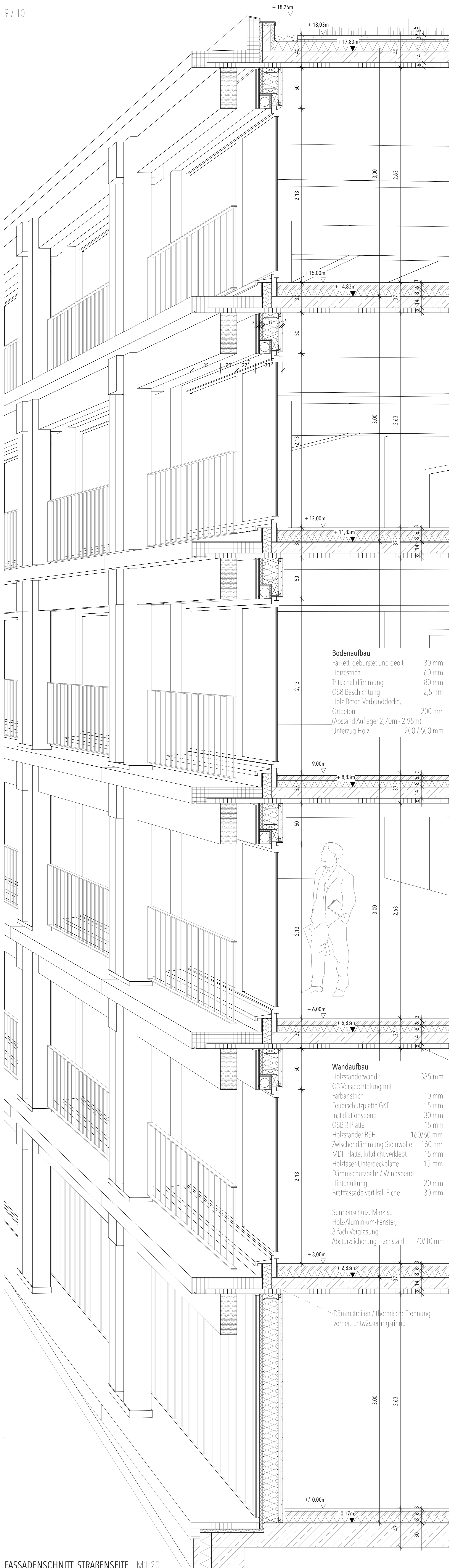
FASSADENSCHNITT STRAßENSEITE M1:20
