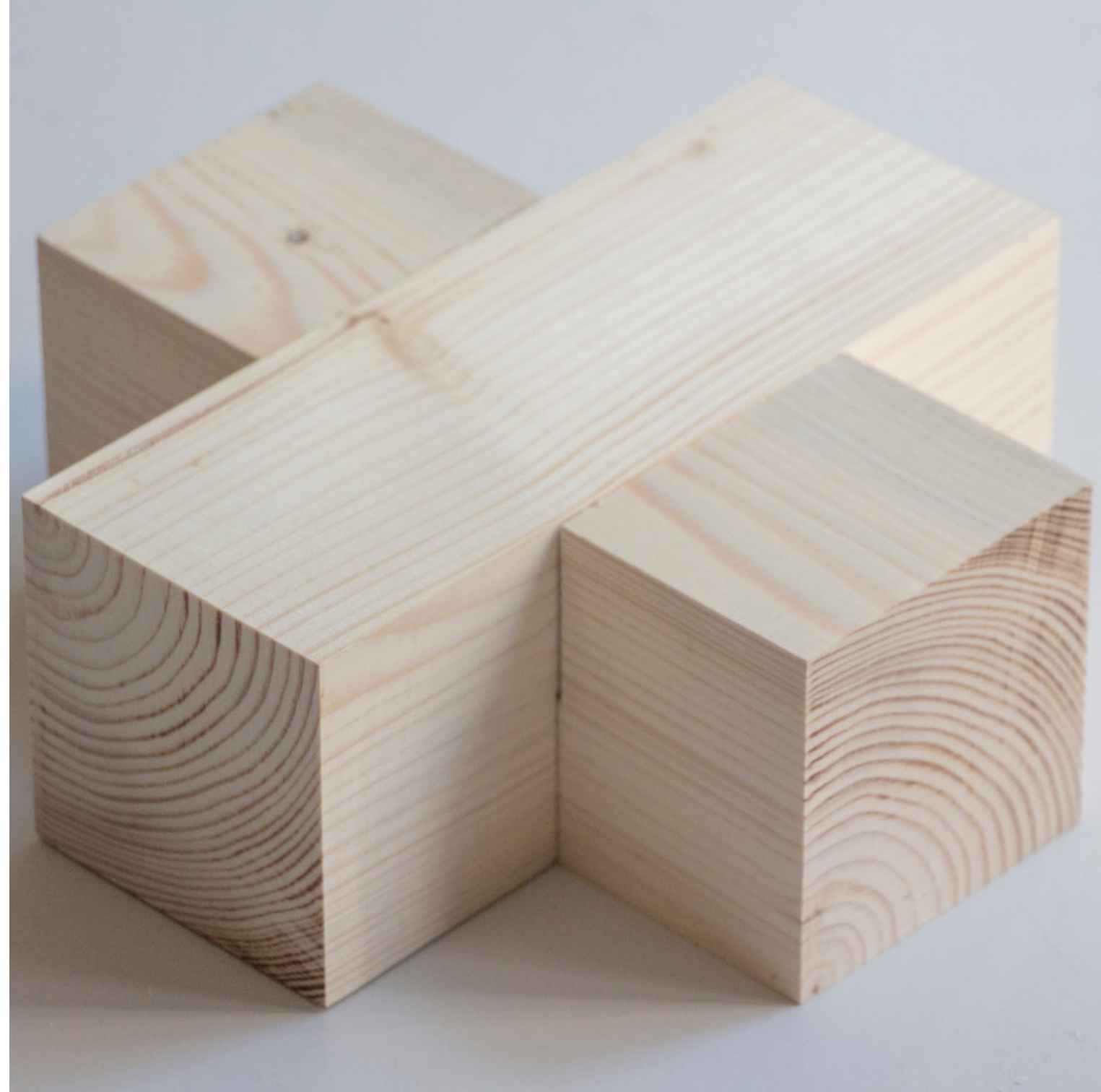
Fügungszeichnung Überblattung | Joint drawing lap joint
